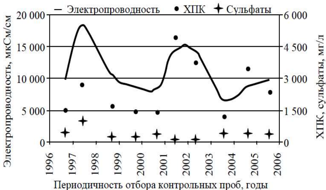
Рис. 1 Изменение отдельных параметров в исходной сточной воде свалки ТБО при контролируемой инфильтрации концентрата в тело свалки.
