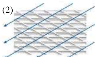
(2) Внутренний поперечный разрез ST-модуля Направление движения жидкости в модуле.
