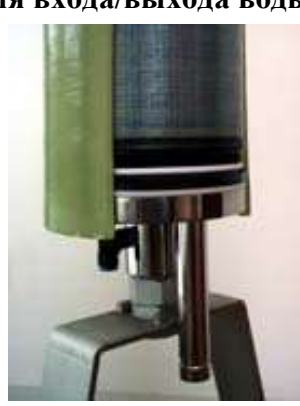
Нижний фланец модуля с подключениями для входа/выхода воды и отвода пермеата
