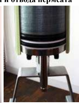
Нижний фланец модуля с подключениями для входа/выхода воды и отвода пермеата
