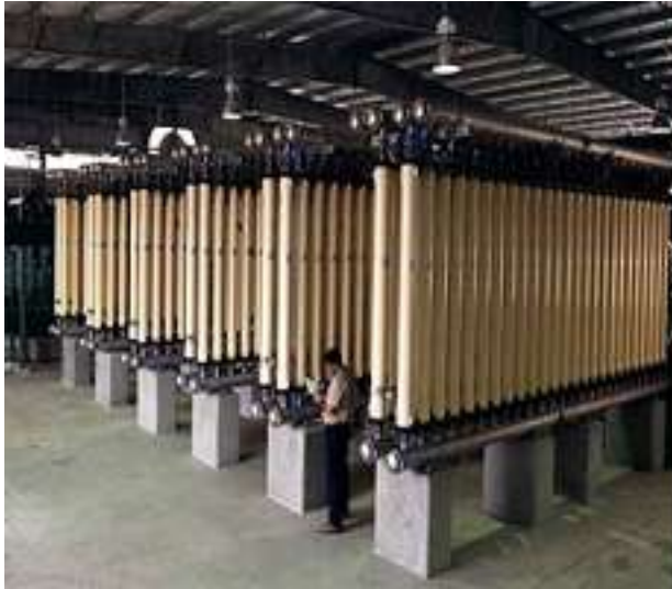
Нетиповая система для получения 1230 м 3 /ч питьевой воды из речной (г. Сан Патрисио, США)
